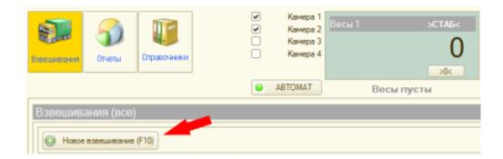
3. **После того как ТС заехало на весы, введите номер транспорта.** Если с данным ТС ранее проводилась операция взвешивания, произойдет автозаполнение полей записи.
