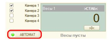
При ее нажатии, вмешательство оператора в процесс больше не требуется, система будет производить все взвешивания автоматическом режиме и результат заносить в журнал. Сама же процедура взвешивания для водителя ТС не меняется и происходит так же, как при двукратном взвешивании.
