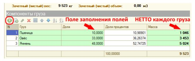
• Раздельное взвешивание грузов с «многократным тарированием». Использование данного метода взвешивания позволяет точно рассчитать значение НЕТТО каждого типа груза размещенных в одном в кузове, в сравнении с методом взвешивания «с приблизительным расчетом».
